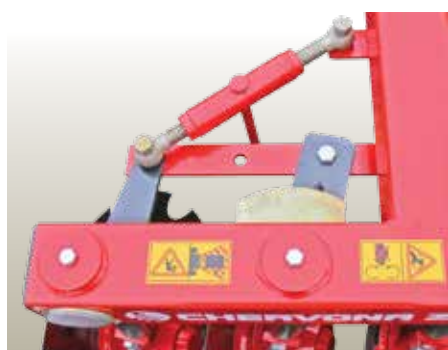
Nastavenie uhlu nábehu pracovných agregátov predného radu brány PALLADA 2400 .
