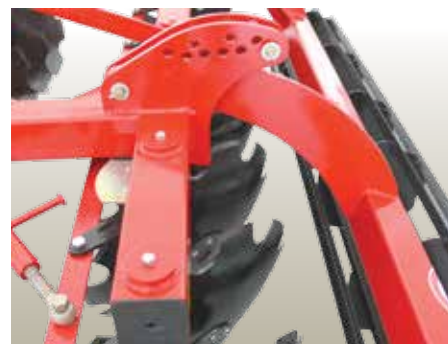
Nastavenie hĺbky spracovania pôdy PALLADA 3200-01 sa uskutočňuje premiestnením osi v otvoroch v držiakoch.
