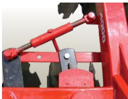
Nastavenie uhlu nábehu pracovných agregátov PALLADA .
