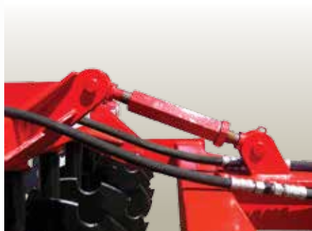
Nastavenie vodorovnej polohy základného a centrálneho uzla diskových brán PALLADA .
