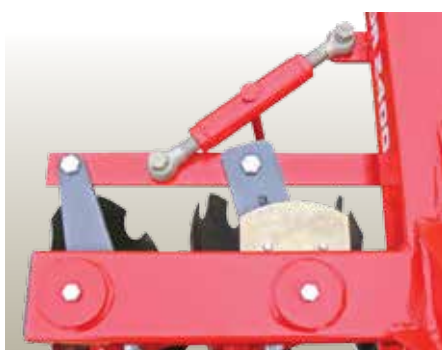
Nastavenie uhlu nábehu pracovných agregátov zadného radu brány PALLADA 2400 .
