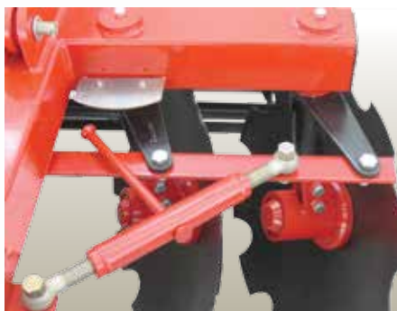
Nastavenie uhlu nábehu pracovných agregátov zadného radu brány PALLADA 3200-01 .
