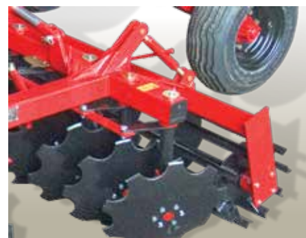
Nastavenie hĺbky spracovania pôdy diskových brán PALLADA .
