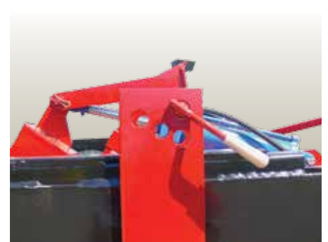
Nastavenie hĺbky spracovania pôdy ANTARES sa uskutočňuje premiestnením osi v otvoroch v držiakoch.
