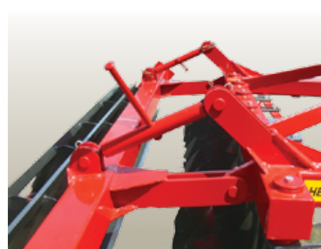
Nastavenie hĺbky spracovania pôdy PALLADA 2400 sa uskutočňuje prostredníctvom lanového napínadla.
